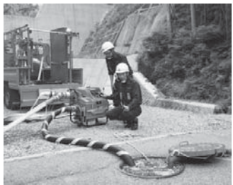
▲防火水槽を使って 中継送水
